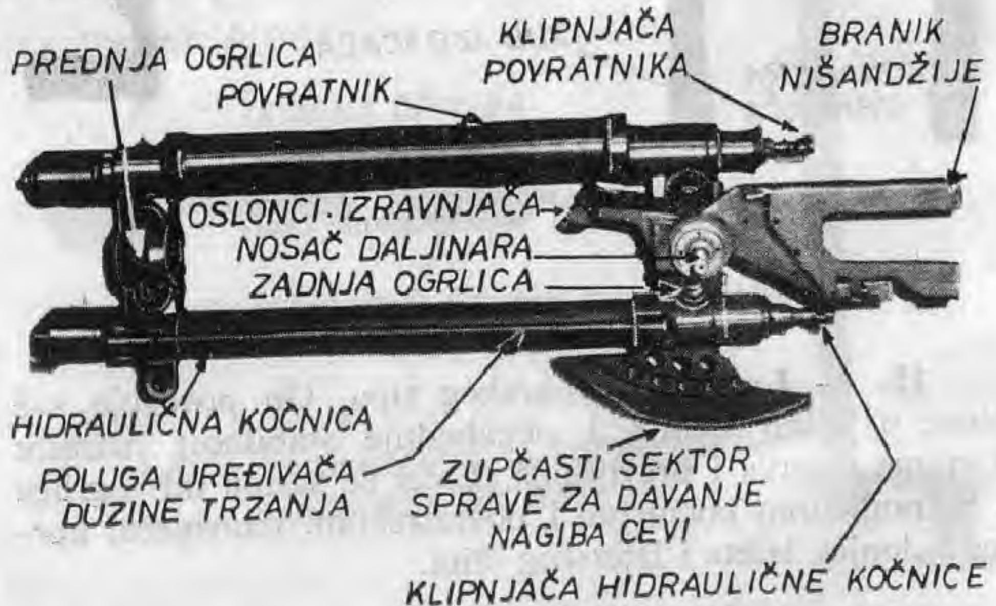
Sl. 9. — Ogrlice sa hidrauličnom kočnicom i povratnikom
